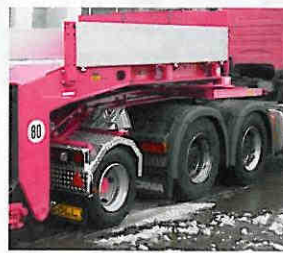
Für noch höhere Nutzlasten wird das 1-Achs-Dolly aufgesetzt
